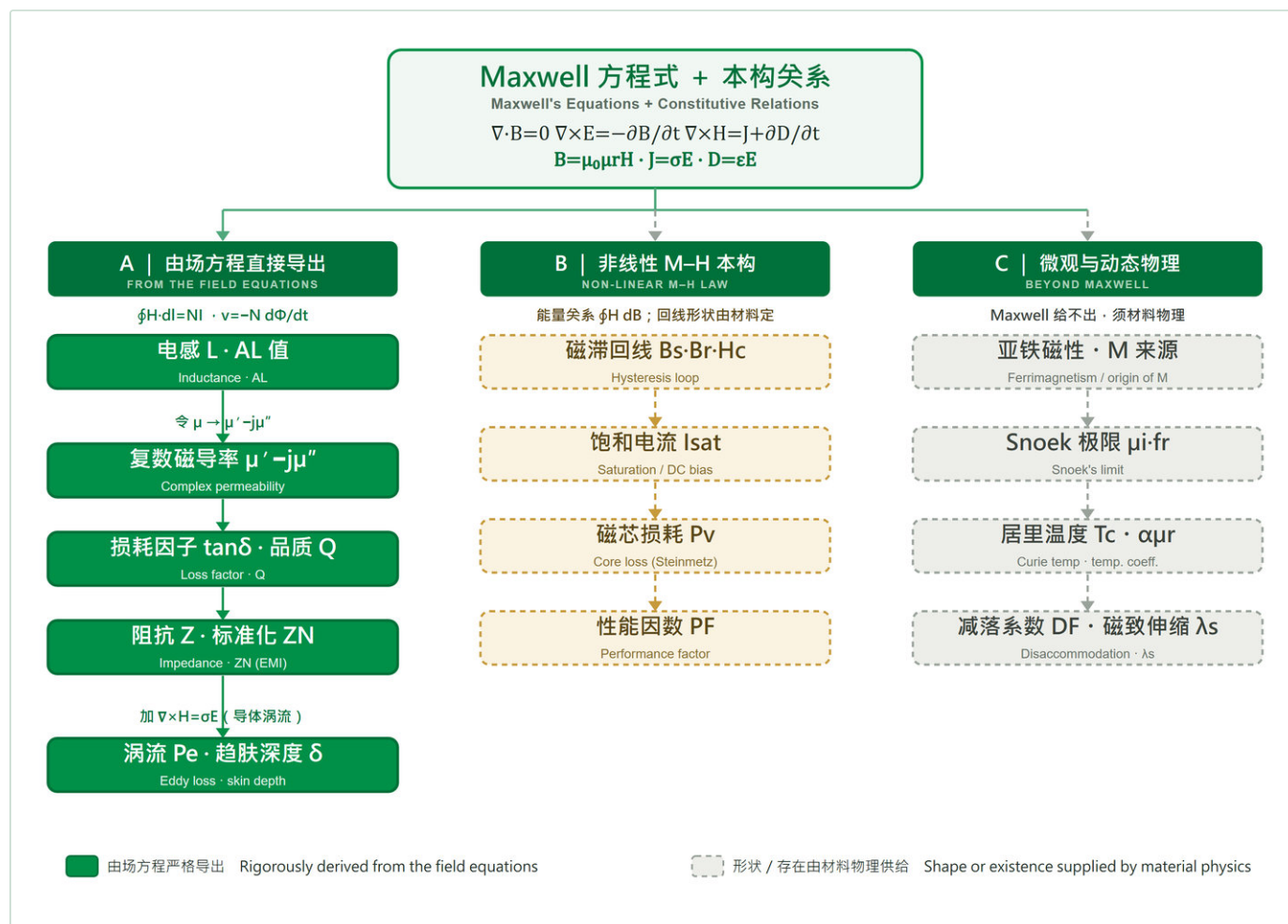
图 T-1 从 Maxwell 方程式到电磁参数：推导地图。实线绿框 = 可由场方程严格导出；虚线框 = 形状或存在须由材料物理供给。
